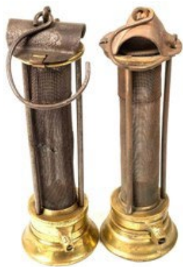
图 1 最早的阻火器：达维安全汽油灯
