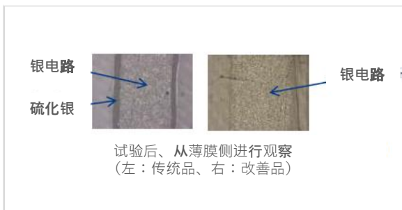
耐硫化试验S气体5.6ppm、85°C×288h
