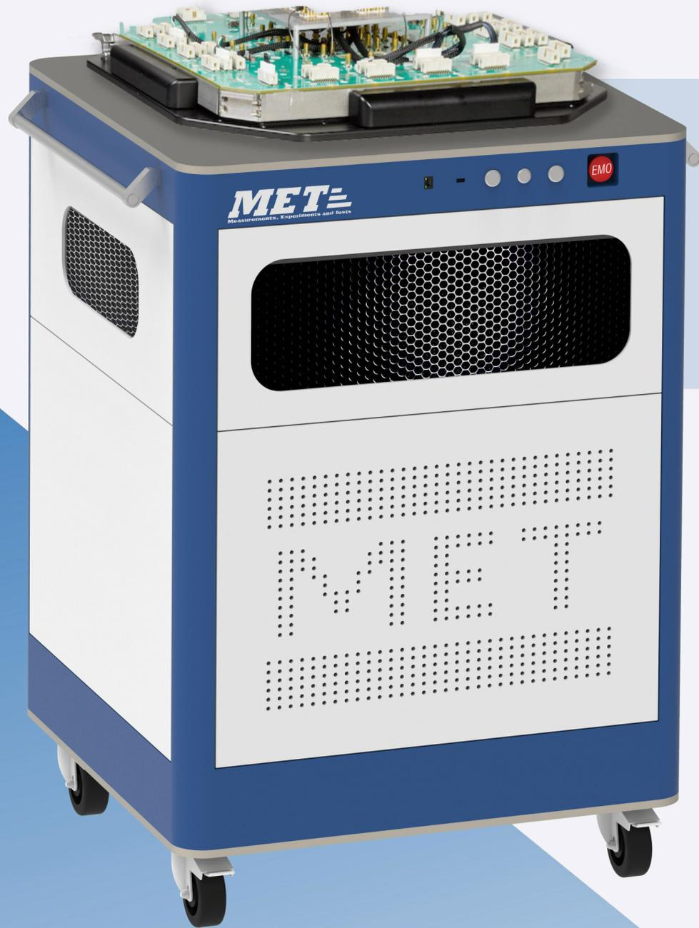
AVARTA-HS系列，高速串行接口测试机，是专为各类具备高速串行传输接口的芯片测试而设计的机台。除量产测试外，AVARTA-HS也是研发调试和表征的测量首选机台。
